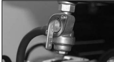
Posuňte páku sýtiče (5) do polohy „START“; = posuňte páku doleva. Pokud je již motor zahřátý není potřeba páku sýtiče přesouvat.
