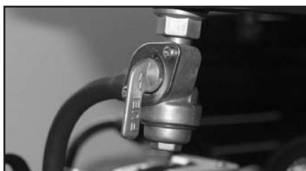
Posuňte páku sýtiča (5) do polohy „I“; „START“ = posuňte páku doľava. Ak je motor už zahriatý nie je potrebné páku sýtiča presúvať.
