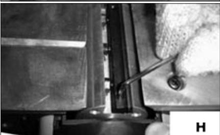
! ! După fixarea cuțitelor strângeți ferm șuruburile de prindere a cuțitelor. Șuruburile de prindere nestrânse pot fi periculoase. Verificați întotdeauna dacă cuțitele sunt bine fixate.
