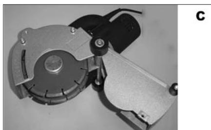
3. Apăsați butonul de blocare pe cap, pentru a imobiliza discul și plasați cheia în deschizăturile marginii exterioare. Rotiți cheia în sensul contrar acelor de ceasornic pentru a slăbi marginea exterioară (D).
