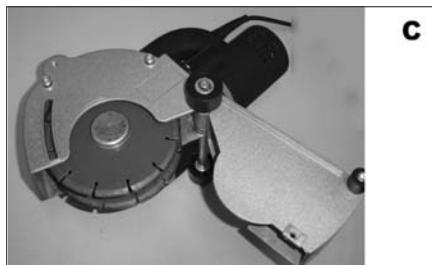
3. Zatlačte blokovací gombík na hlavici, aby ste kotúč zablokovali a do otvorov na vonkajších prírubách vložte kľúč. Kľúč otáčajte proti smeru hodinových ručičiek, aby ste uvoľnili vonkajšiu prírubu. (D)
